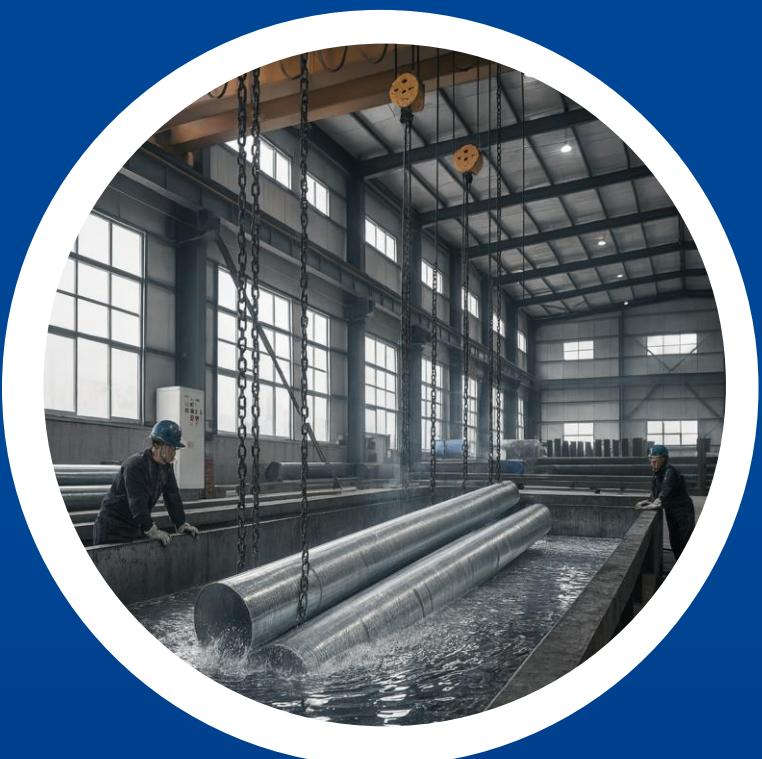
**Durabilidade:** A durabilidade da estrutura é diretamente proporcional a espessura da camada de recobrimento do zinco e ao ambiente onde a estrutura será inserida. Determinada essas variáveis, é possível fazer uma estimativa de durabilidade do produto.
